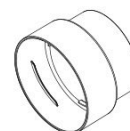
Соединитель трубы 3.64 inch (совместим с выхлопными трубами 3.58 inch)
