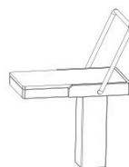
Épingles de maintien du matériau
